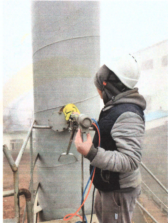
DA003重板废气排放口采样
