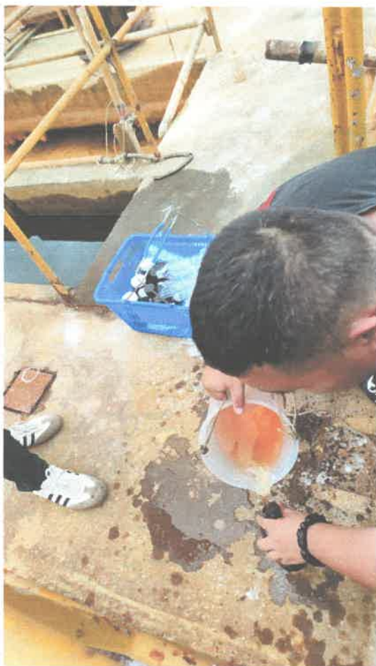
李屋拦泥库一期处理前废水采样
