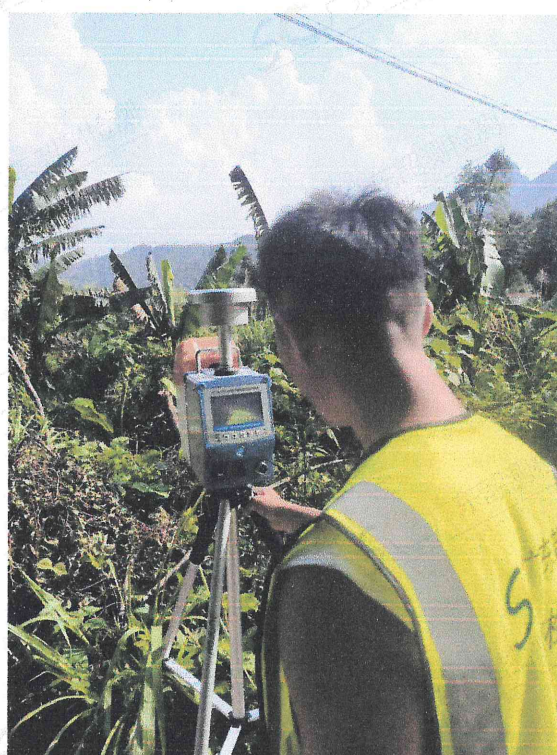
一号公路中段无组织废气采样
