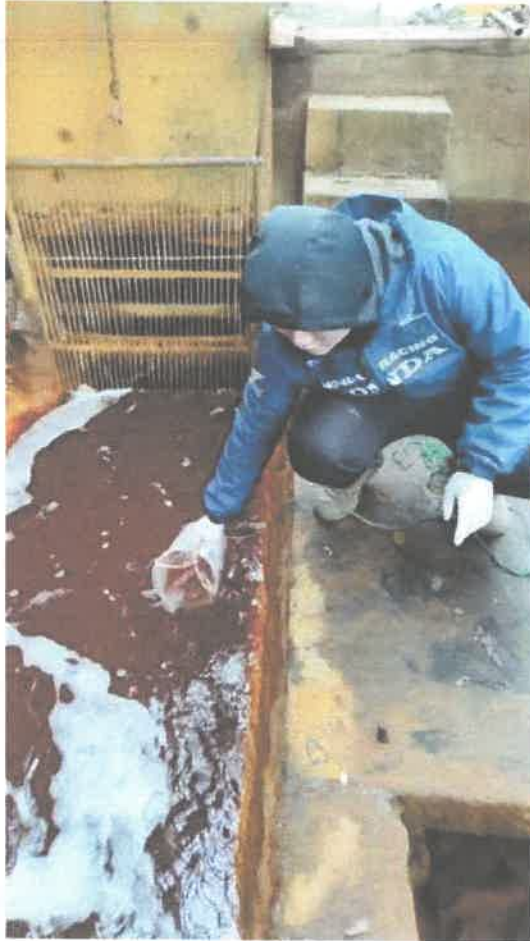
李屋拦泥库一期处理前废水采样
