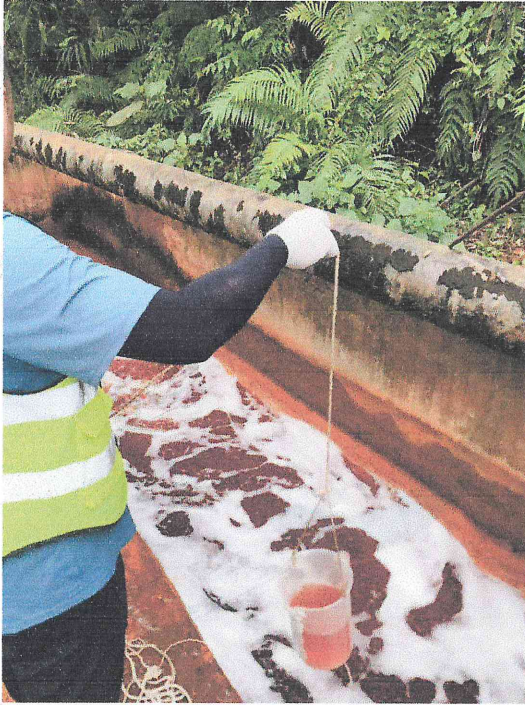
李屋拦泥库一期处理前废水采样
