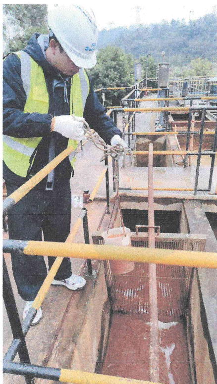
李屋拦泥库一期处理前废水采样
